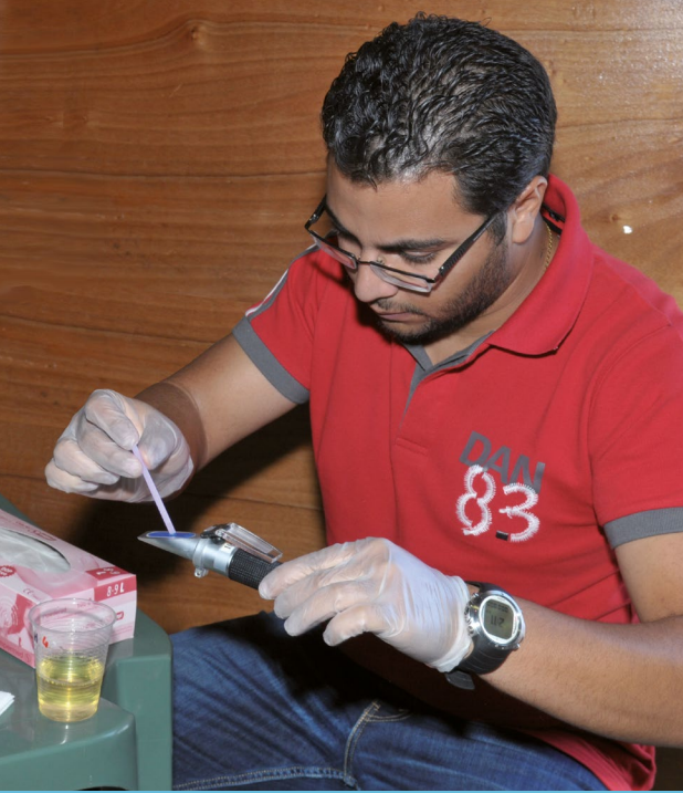
DAN Europe Araştırmacılarından biri DAN Research etkinliğinde İdrar Yoğunluğu testi yapıyor. Bu test dalıcının su alımı durumuna göre idrar özgül ağırlığını belirler
